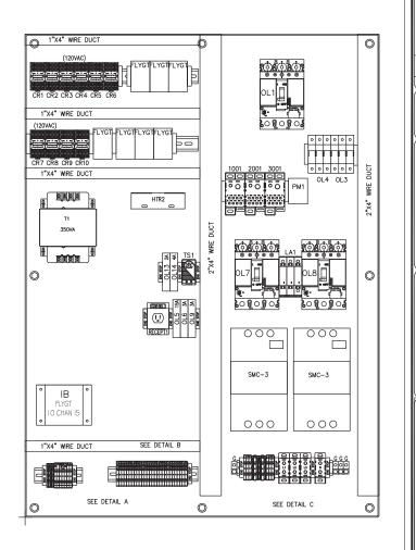
UL LISTED LIFT STATION CONTROL PANEL & PUMP DISCONNECT PANEL—UDUREX PUMPS WITH OPTIONAL PERMARENT ON—SITE ELECTRICAL GENERATOR. CONTROL PANEL LAYOUT ELECTRICAL CONTROLS DUPLEX LIFT STATION SYSTEM
