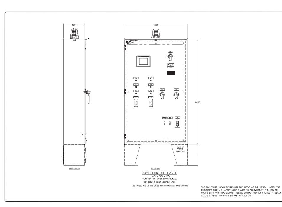
DUPLEX CONTROL PANEL LAYOUT MICROLOGIXS DUPLEX CONTROL
