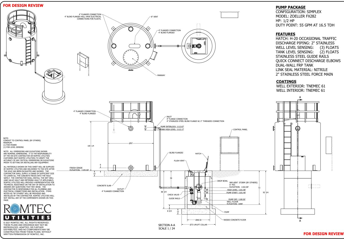
STORMWATER PUMP STATION SYSTEM DRAWING
